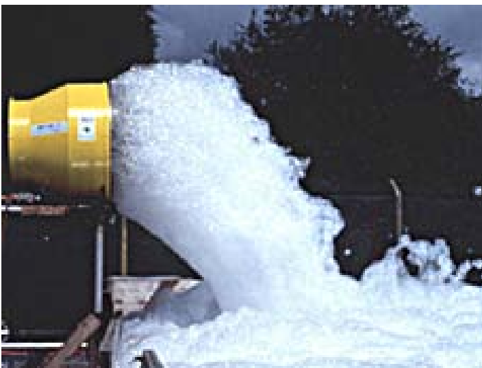
LGE Sintex Expandol sendo utilizado com gerador Turbex de alta expansão.
